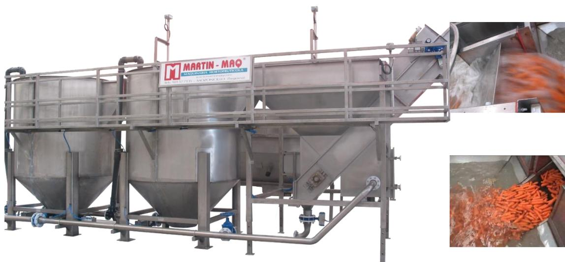
Nuestro exclusivo y novedoso sistema de remojo circular de la serie SRC es ideal para realizar la función de prelavado cuando la materia prima (zanahorias, patatas, etc.) está muy sucia y las máquinas de lavado tienen dificultad para eliminar la suciedad.
