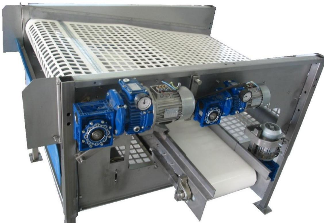
La gama de calibradoras de malla de la serie CM son las máquinas ideales para calibrar patatas, cebollas, remolacha de mesa, ajos, etc.
