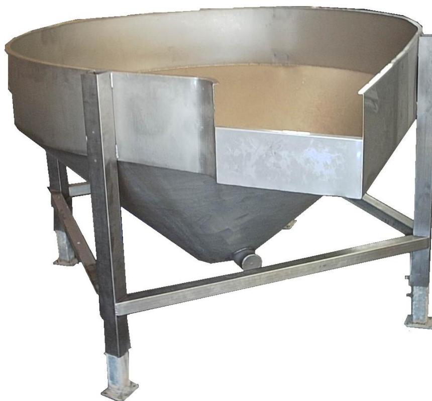
La gama de depósitos de la serie DRC están diseñados para recuperar y decantar el agua procedente de su línea de procesado.
