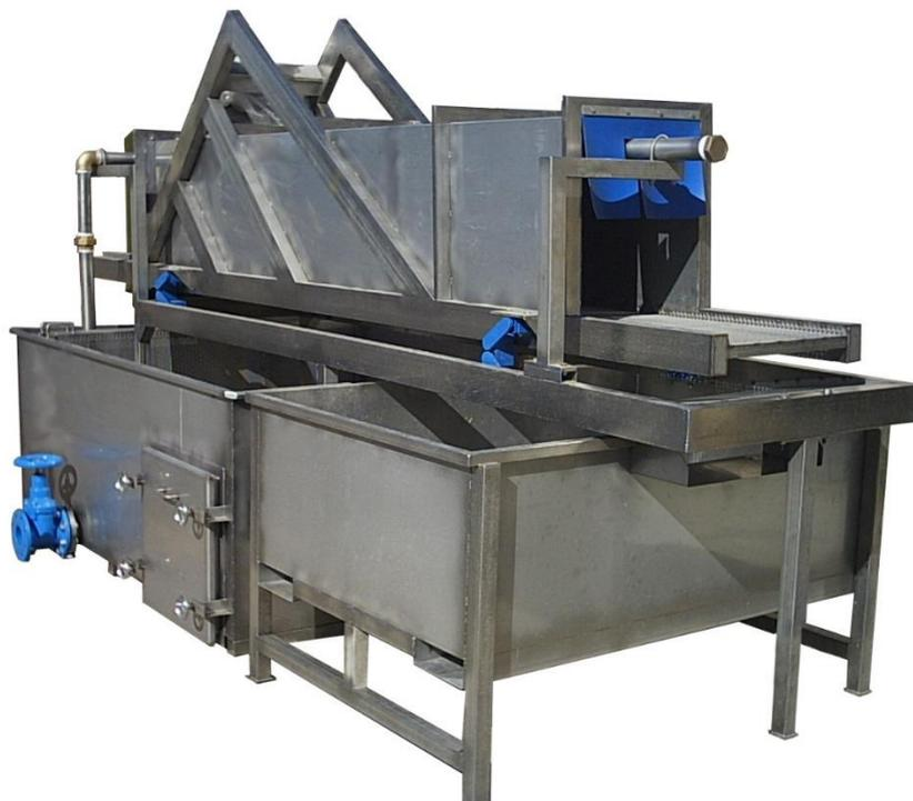
Nuestra gama de lavadoras de planta de fresa son las máquinas adecuadas para efectuar una cuidadosa limpieza de los plántones de fresa.
