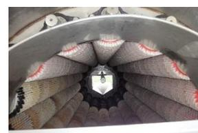
La nueva gama de peladoras de la serie PE cuentan con un bombo giratorio compuesto por filas de cepillos de diseño exclusivo de Martin Maq.
