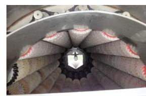
La nueva pulidora de la serie PBC cuenta con un bombo giratorio compuesto por filas de cepillos de diseño exclusivo de Martin Maq.
