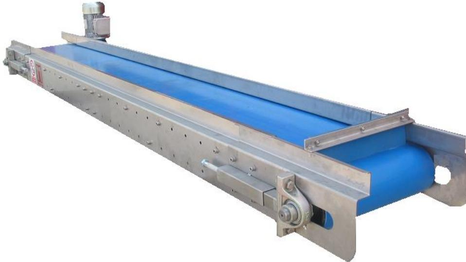
La gama de transportadores horizontales de la serie TDH son las máquinas adecuadas para trasladar horizontalmente de una máquina a otra hortalizas frescas y otros materiales de la manera más delicada posible.
